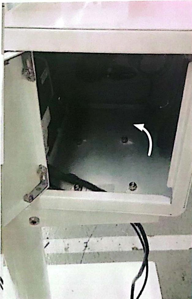
**D. Faire pivoter légèrement la boîte monétique dans le sens inverse des aiguilles d'une montre pour caler les vis dans les encoches.**
